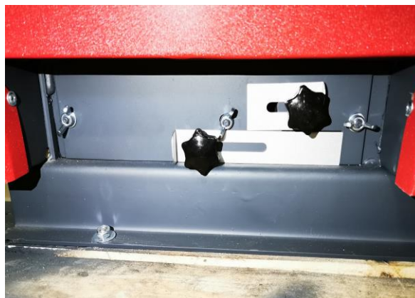
Abbildung 9: Lage der Klappen für die Sekundärluftzufuhr
