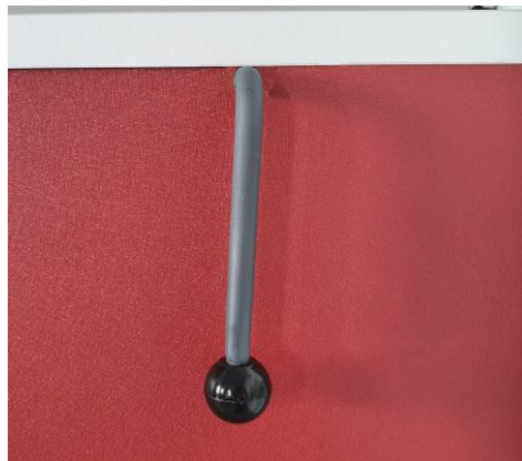
Abbildung 8: Kurzschlussklappenhebel in geschlossener Stellung.
