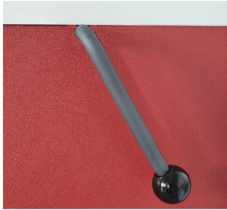
Abbildung 7: Kurzschlussklappenhebel in geöffneter Stellung.
