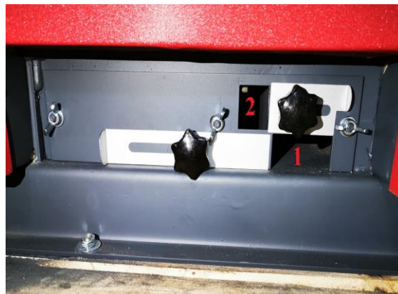
Abbildung 11: Einstellung der Sekundärluftmenge
